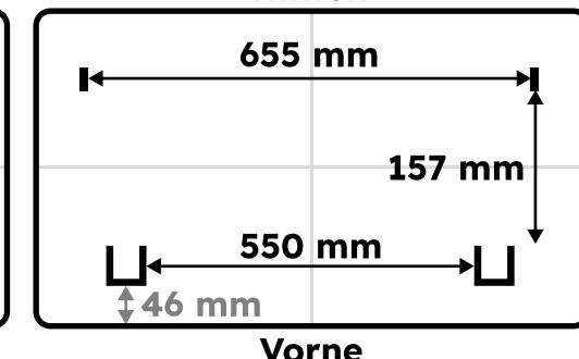
Befestige die mitgelieferten Teile an der Unterseite deiner Tischplatte. Beachte hierbei die Ausrichtung und Abstände zwischen den einzelnen Teilen, da diese für die korrekte Funktion essentiell sind.
